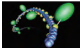
高気密性ENラバーの分子 主原料である改質天然ゴムは、合成ゴムのような「枝葉」を持つため、空気を通しにくい
