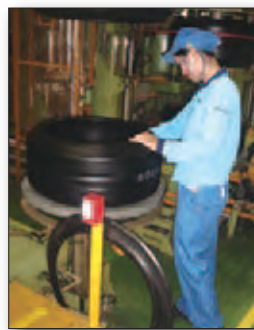
作業台を低くすることで、 女性でも作業しやすくしています
